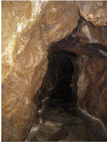
**Titel:** Erster Querschlag nach links mit Holzeinbauten in der oberen Grube Fliden
